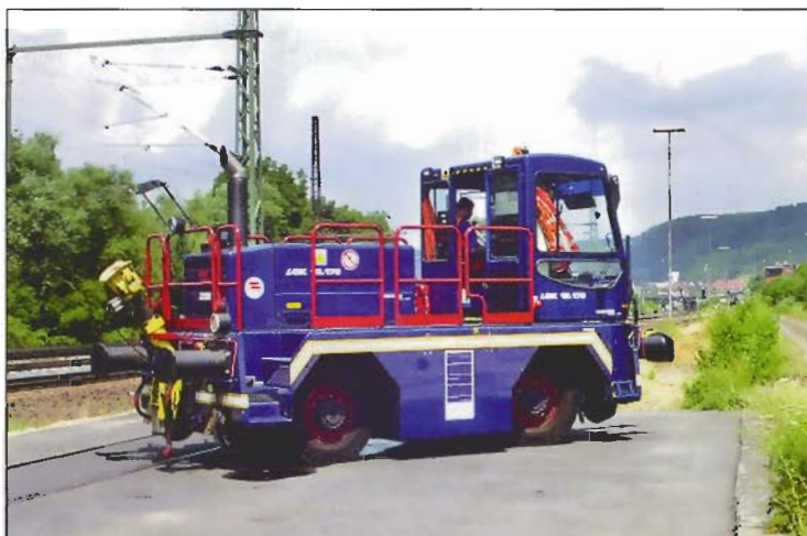
Abb. 9: Zwei-Wege-Fahrzeug beim Umsetzen am Streckenende in Weinheim
